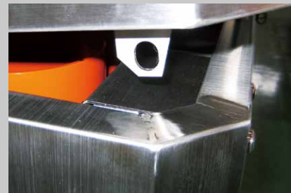
ソレノイドロック扉側フック / Electric Door Lock of The Hook on The Door Side.
