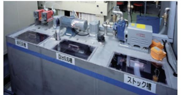
従来の凝集沈澱式では必要な、高分子凝集剤凝集槽、凝集沈澱槽がOstleでは不要となります。
