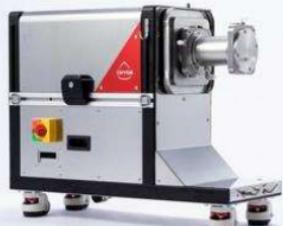
【名古屋】チップトン（名古屋市南区、小林史明社長、052・692・6666）は水中で特殊な渦を起こし加工対象を最小で直径数十ナノメートル（ナノは10億分の1）まで任意の大きさにできる装置「テイラーボルテックス・フロー（TVF）＝写真」を開発、受注を始めた。粒度分布は最狭プラスマイナス10%内で、加工時間も最短数秒と短い。次世代の医薬品や電池材料などの量産化に需要が期待できる。
