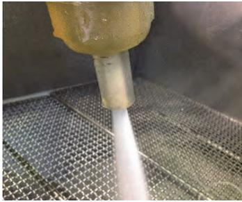
ウェットブラストとは、ブラスティングの一種で湿式ブラストともいい、粒子と液体を混ぜ合わせたスラリー液を噴射ガン部において圧縮空気の力を使って加速し、対象物に吹き付けて加工を行う方法です。
