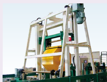
バレル槽搬送中
