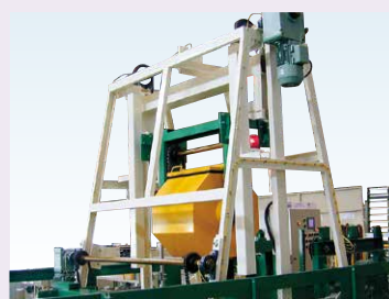
バレル槽搬送中
